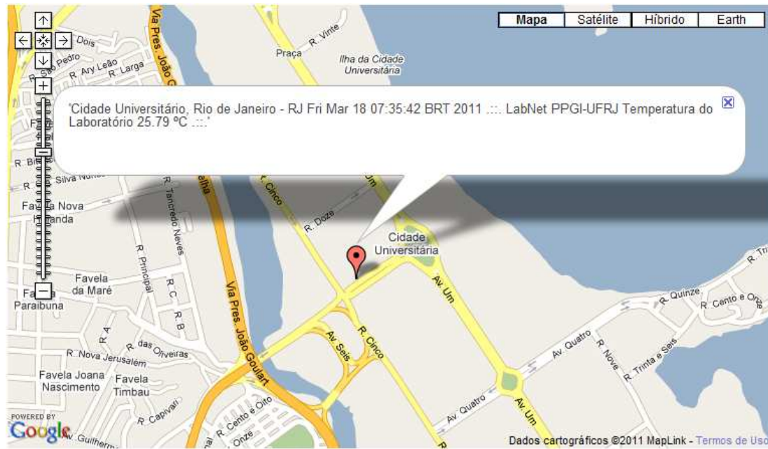
Figura 3.31 - Mashup físico que apresenta em uma mapa da Web a localização de um SPOT e o valor da temperatura local obtida através do acesso Web ao dispositivo de sensoriamento desse SPOT
