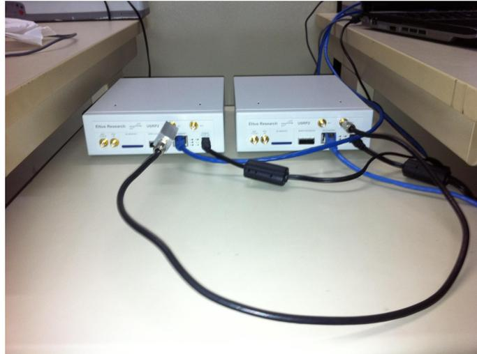
**Figura 3. Fotografia dos dispositivos USRP2 conectados através do cabo coaxial RG-58C.**
